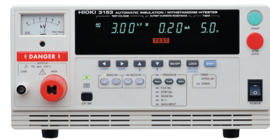
Tester rigidità dielettrica, resistenza isolamento, ground bond e leakage
