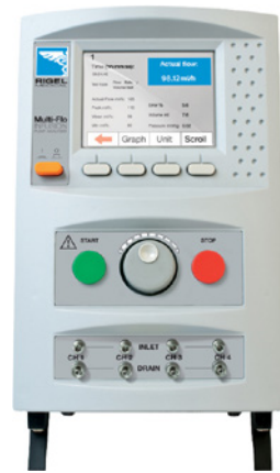
Multi Flo. Verificatore per pompe a infusione
